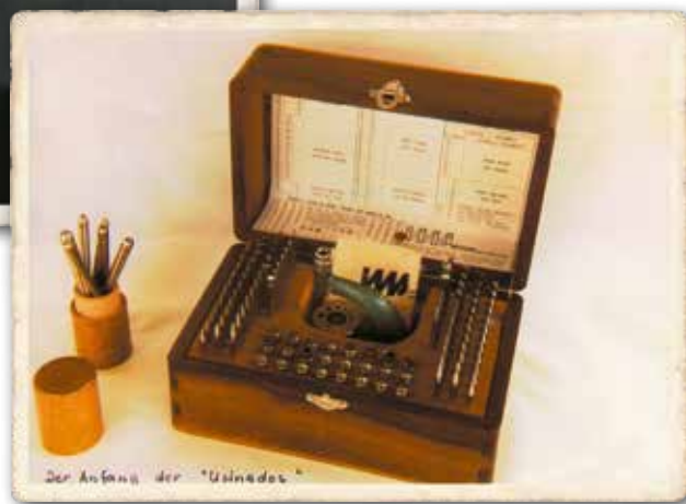
Anos 70 - antes do registro formal do negócio. O início da Usinados: punçoneiras e punção de mola, ferramentas básicas para um bom relojoeiro
